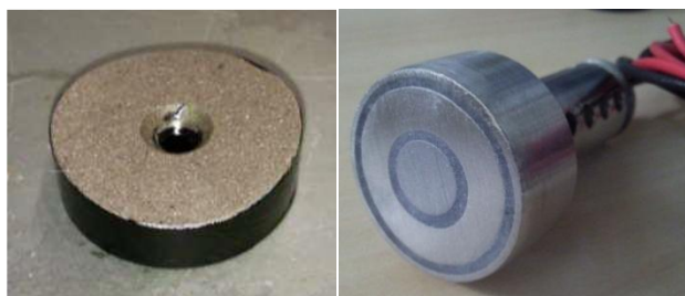
Figura 2. Cupom da técnica CPM (esquerda) e eletrodo das técnicas LPR e EIE (direita).
