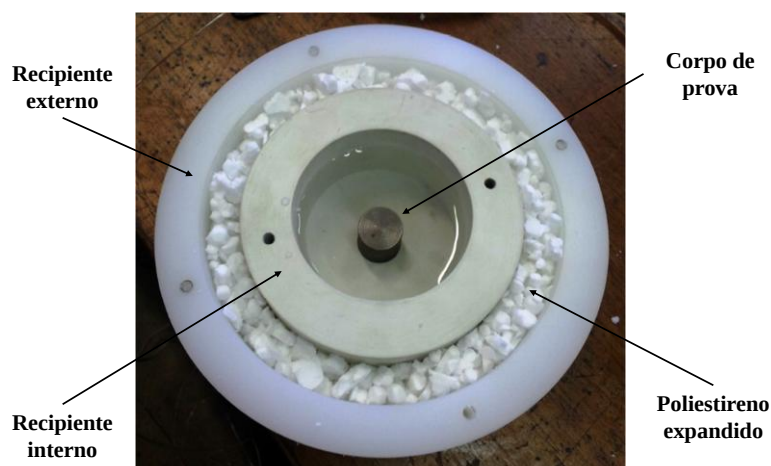
Figura 2. Calorímetro de água com isolamento de poliestireno expandido. O corpo de prova é fixado por parafuso Allen com cabeça M6 x 10 mm. No interior do calorímetro foi adicionado 90 ml de água deionizada.
