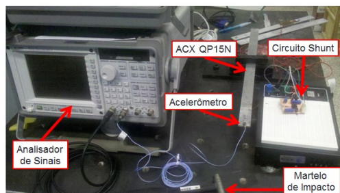
Figura 1: Esquemático dos ensaios (à esquerda) e Montagem Experimental (direita).
