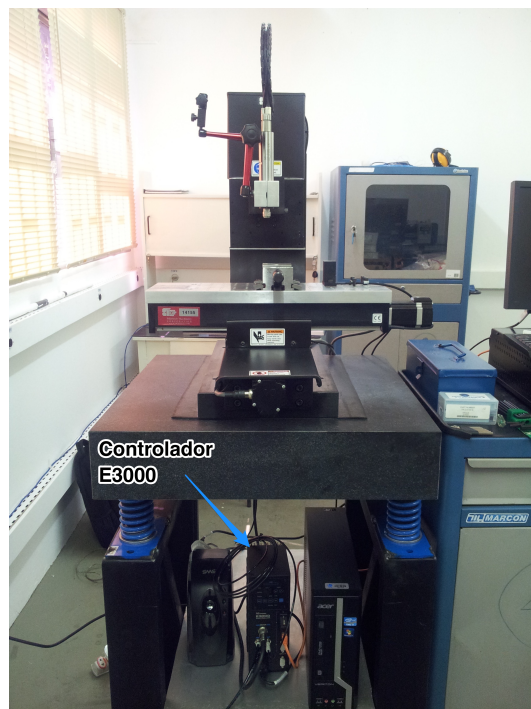
Figura 1. Máquina para teste de microfresamento
