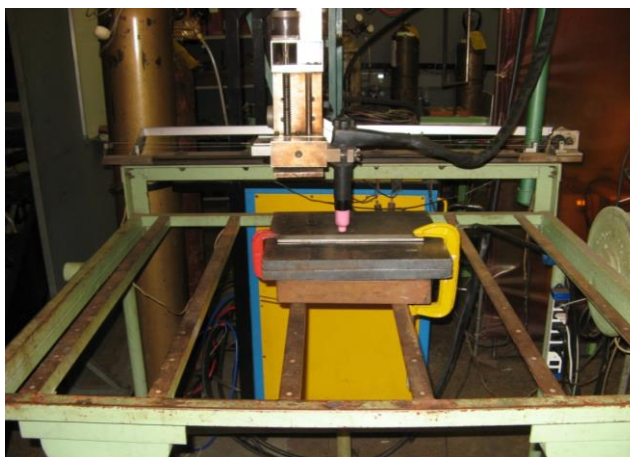
Figura 3. Mesa de coordenadas XY para manipulação da tocha de soldagem
