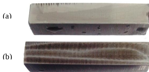
Figura 2 – Amostras de Aço-Rápido utilizadas no ensaio: (a) sem queima, (b) com queima.
