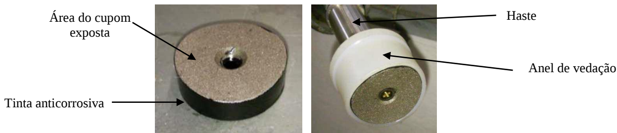
Figura 3. Cupom de perda de massa de VMEC 134 AP
