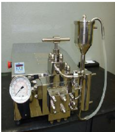
Figura 1. Homogeneizador de Alta Pressão – AP-LAB 10LTS – LEST – UFU.
