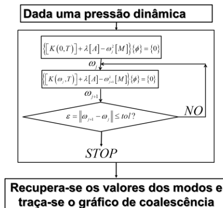
Figura 2. Fluxograma do algoritmo do processo iterativo para resolução do problema não-linear de autovalor
