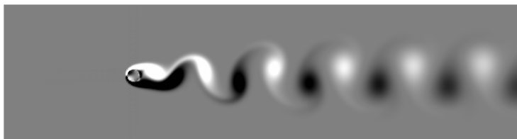
Figura 3: Vorticidades liberadas para o escoamento em Re = 100 , ao tempo de 240 segundos.
