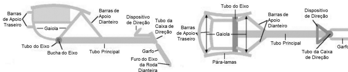
Figura 4. Cadeira de rodas de corrida vista frontal e superior (BLEAKNEY, 2004)
