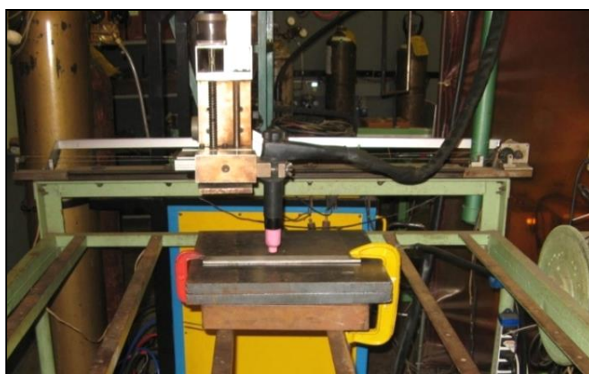
Figura 4. Mesa de coordenadas para manipulação da tocha de soldagem TIG
