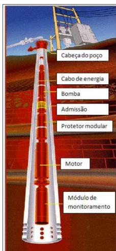
Figura 1. Bombeio Centrífugo Submerso (Catálogo REDA)
