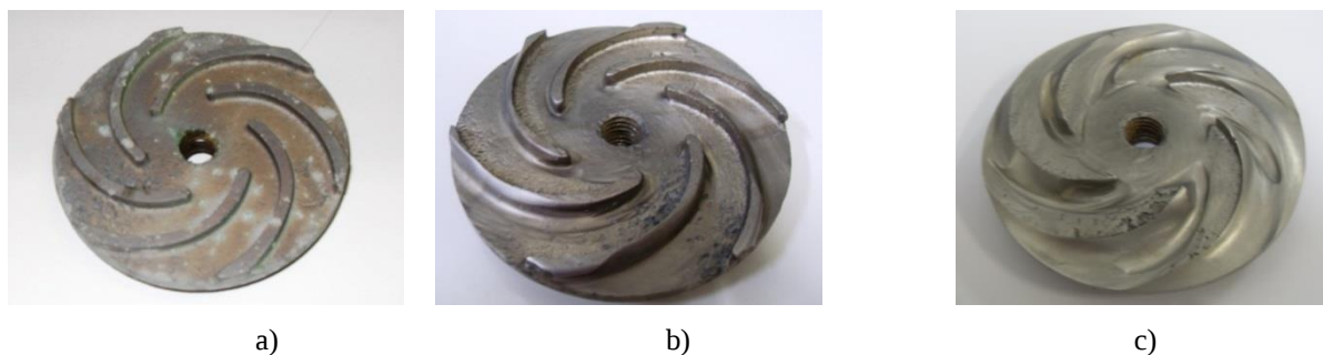
Figura 3 – Rotor utilizado nos testes a) condição inicial; b) após 4 horas de teste e c) 12 horas de teste.
