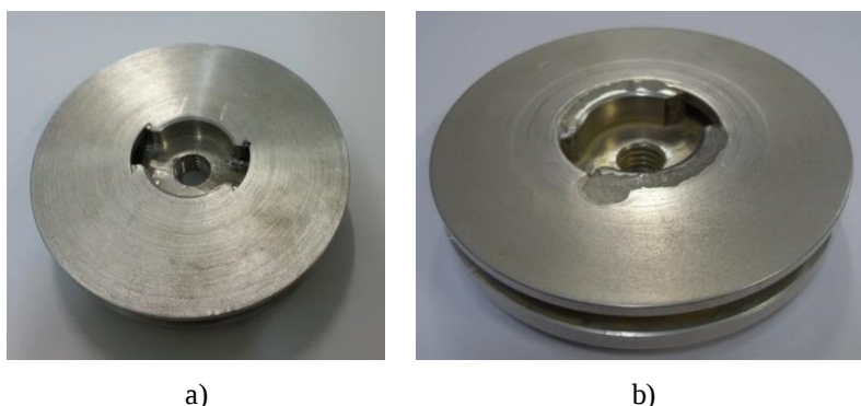
Figura 5 – a) Protótipo 1.5 sem uso e b) após 56 horas de funcionamento.
