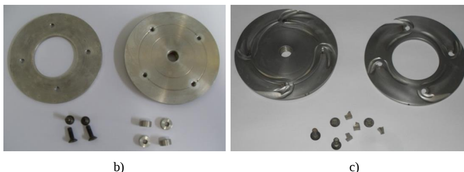
Figura 4 – a) Desenho em AutoCad do protótipo; b) e c) Comparativo do protótipo 1.1 sem uso e após 12 horas de bombeamento.
