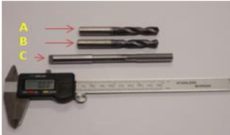
Figura1 – Ferramentas utilizadas nos ensaios: (a) broca de diâmetro igual a 9,5mm; (b) broca de diâmetro igual a 9,7mm, (c) alargador de diâmetro igual a 10 mm
