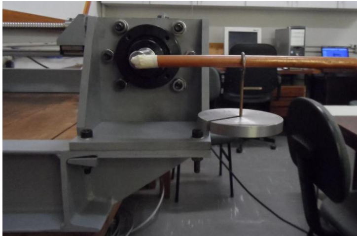
Figura 3. Experimento para a determinação do torque de atrito estático.
