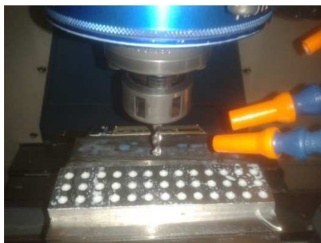
Figura 1. Ferramenta de corte e corpo de prova montados na máquina.
