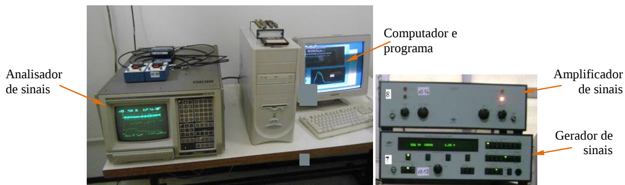
Figura 2. Sistema de medição utilizado para monitoramento das vibrações.
