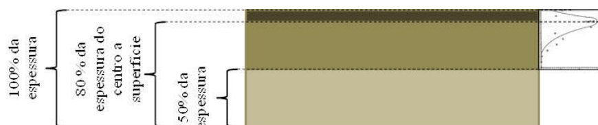
Fig. 2. Espessuras de comparação para os aços P430E e P430A.
