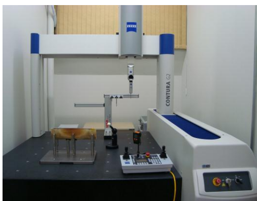
Figura 1 - MM3C utilizada no desenvolvimento do trabalho, fabricada pela Carl Zeiss, modelo Contura G2 RDS/XXT
