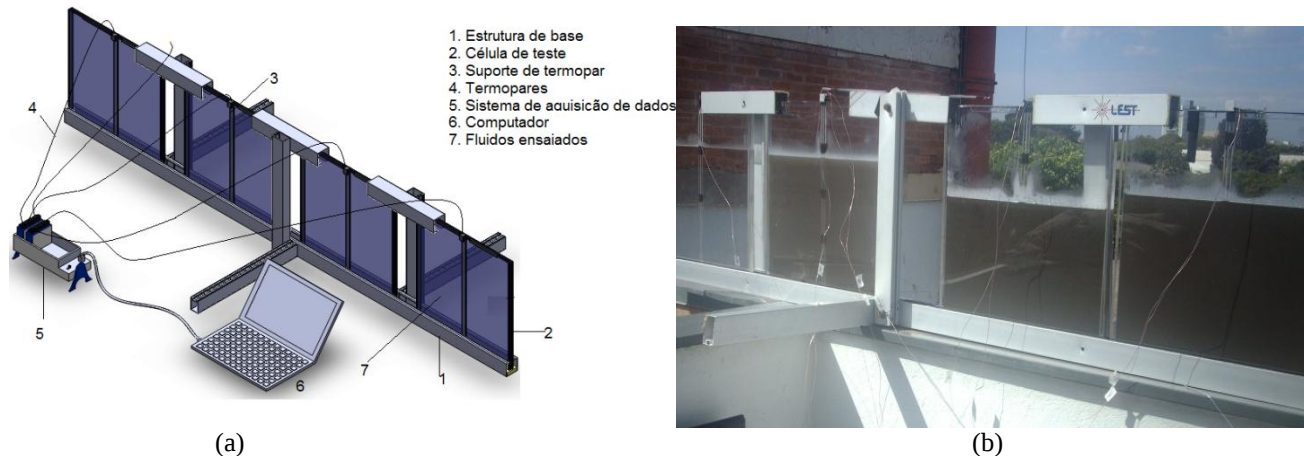
Figura 2. Aparato experimental a) visão esquemática e b) foto do sistema no dia do teste
