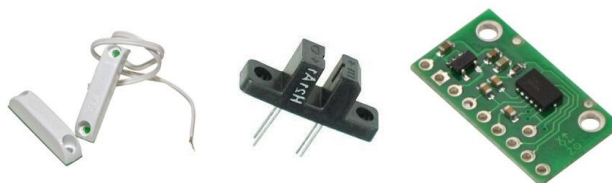
Figura 4. Sensores do CONPARTE: magnético 9028PA (esquerda), sensor transmissivo óptico TCST1103 (centro) e acelerômetro MMA7361L (direita).
