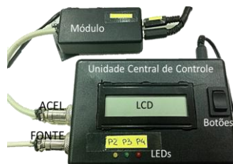
Figura 5. CONPARTE: sistema real e seus componentes.
