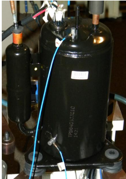
Figura 1. Pontos de medição da vibração nos compressores.
