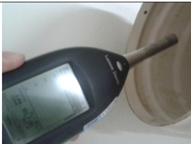
Figura 14. Decibelímetro medindo 83,7 dB antes do Controle Ativo de Ruído
