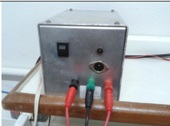
Figura 8. Fonte de alimentação com transformador de 12V para os amplificadores.
