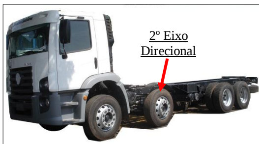
Figura 1: Caminhão com quarto eixo direcional
