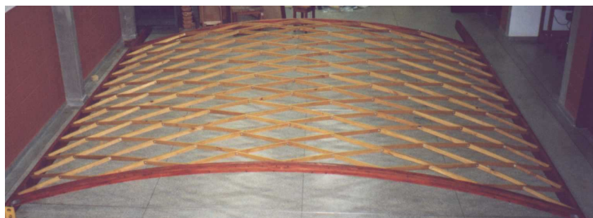
Figura 1: Protótipo lamelar (5 m x 4 m) construído na EESC-USP. Fonte: FERREIRA (1999).
