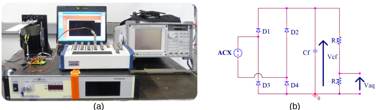
Figura 7: (a) Aparato experimental para geração de energia elétrica; (b) Circuito retificador padrão.
