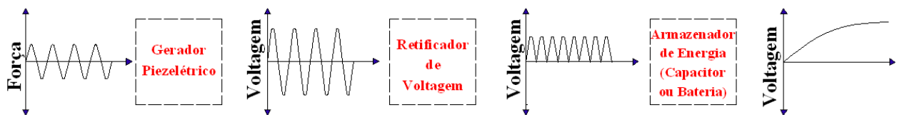
Figura 3: Componentes de uma estrutura geradora de energia, incluindo o acoplamento do circuito à estrutura (adaptado de RUPP et al., 2009).
