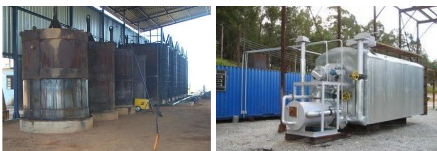
Figura 3: Fornos Metálicos: Cilíndricos Verticais (Colombo, 2006) e container (DPC biomassa), respectivamente.
