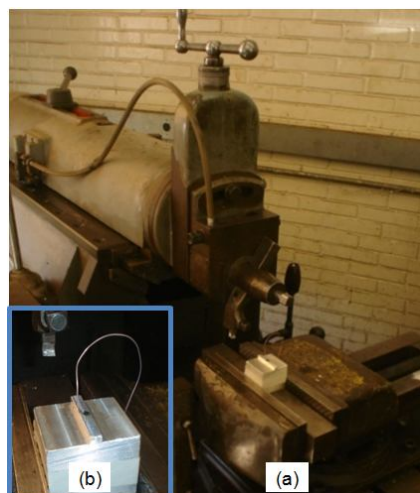
Figura 2 – (a) Máquina-Ferramenta Plaina STRIGON GH 560/M e (b) Detalhe do termopar.
