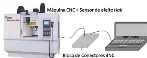
Figura 1: Esquema do sistema de aquisição de potência utilizado durante os testes.
