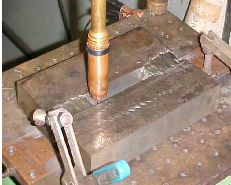
Figura 2: Ilustração dos Corpos de Prova para Ensaio Tekken com as soldas de ancoramento.
