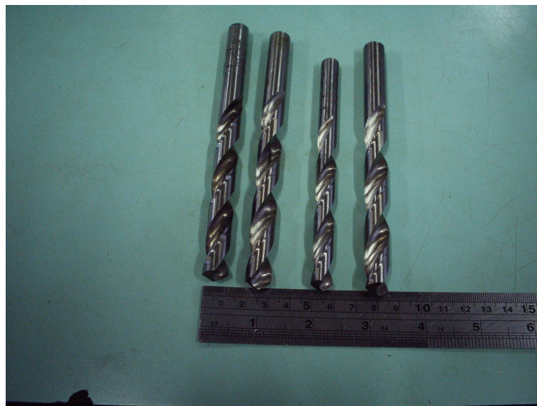
Figura 1 – Brocas de HSS utilizadas nos experimentos de teste de furação constante.
