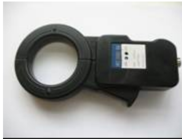
Figura 2: Sensor Hall usado para medição de corrente de soldagem
