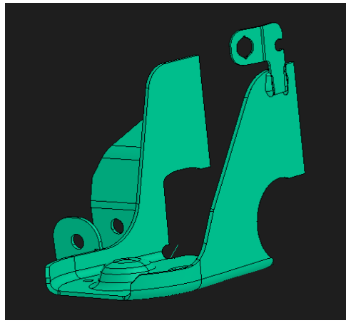
Figura 6: Modelo mostrando as peças a serem soldadas.
