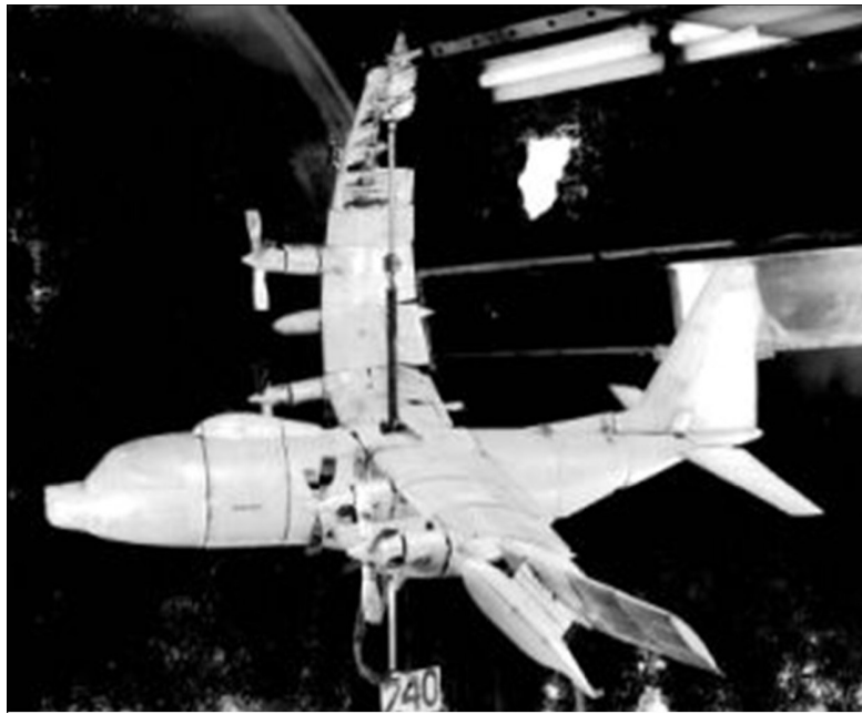
Figura 1: Maquete de uma aeronave em túnel de vento sofrendo os efeitos do flutter.
