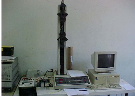
Figura 2: Máquina Universal de ensaio de bancada, modelo VERSAT 500.
