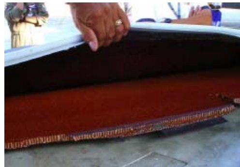
(b) Descolamento em uma estrutura composta (Honeycomb).
