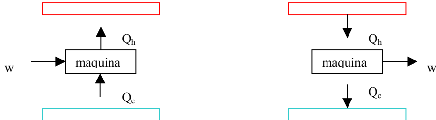
Figura 1- Bomba de calor e refrigerador respectivamente
