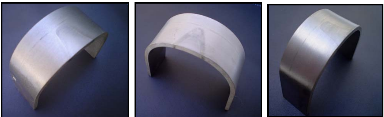
Figura 13: Amostras após a Realização do Ensaio de Dobramento.
