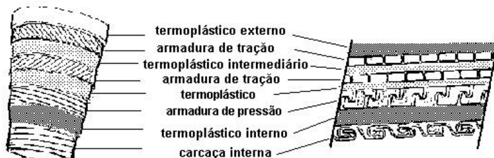
Figura 2: Estrutura de Um Duto Flexível (Chen, 1995)
