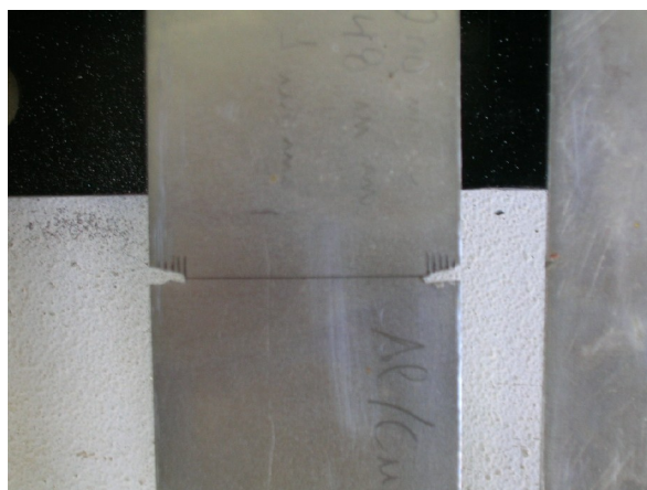
Figura 4 - Viga engastada-livre de alumínio-cobre com fissuras.
