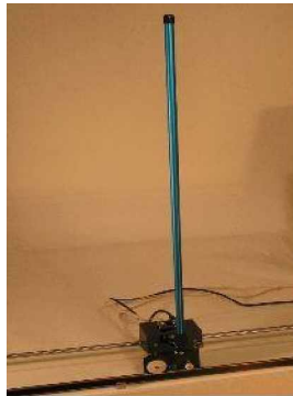
Figura 1: Sistema pêndulo invertido, designado por IP02.
