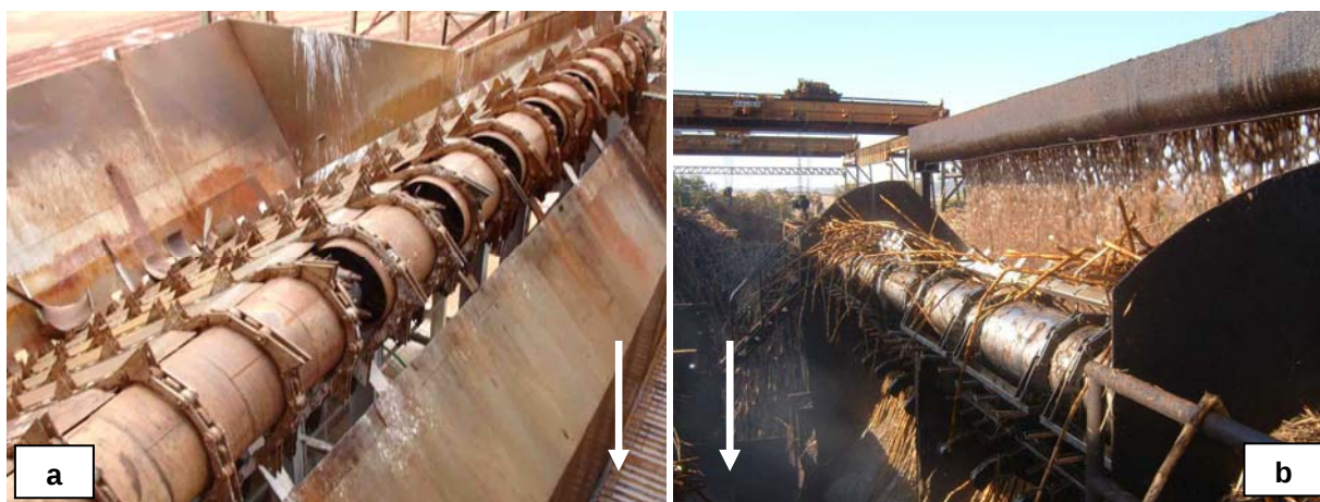
Figura 2 – detalhe da mesa alimentadora durante a parada (a) e em operação (b).
