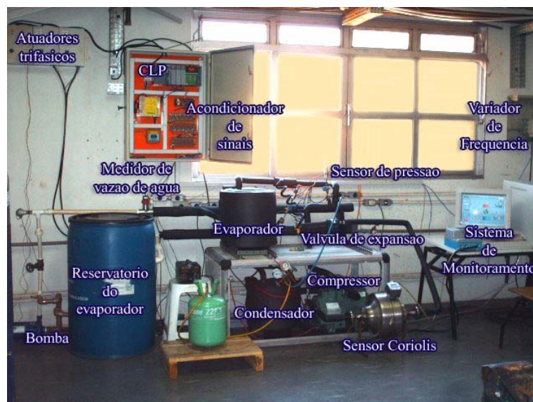
Figura 2. Foto do sistema de refrigeração de compressão a vapor.
