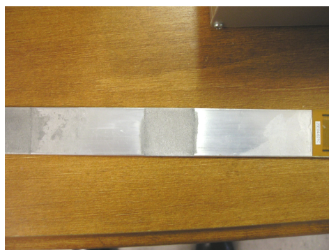
b) Exemplo de uma corrosão leve
