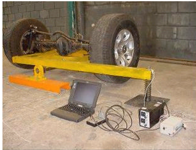
Figura 2 - Instrumentação usada no ensaio para determinação do momento de inércia.
