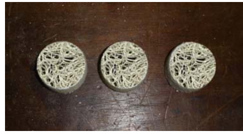
B) - Amostras recortadas para medições no tubo de impedância
