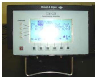
C) - Amplificador de Microfone: Conditioning Amplifier NEXUS; Brüel&Kjaer
