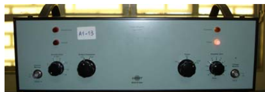
B) - Amplificador de Sinais: Power Amplifier Type 2712; Brüel&Kjaer
