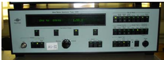
A) - Gerador de sinais: Sine/Noise Generator Type 1049; Brüel&Kjaer
