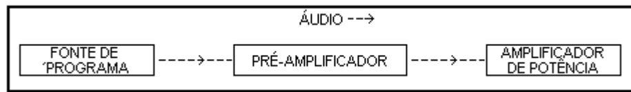
Figura 1: Sistema simplificado de áudio.
