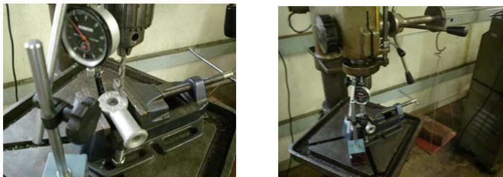
Figura 1: Montagem experimental do teste de usinabilidade de pressão constante.
