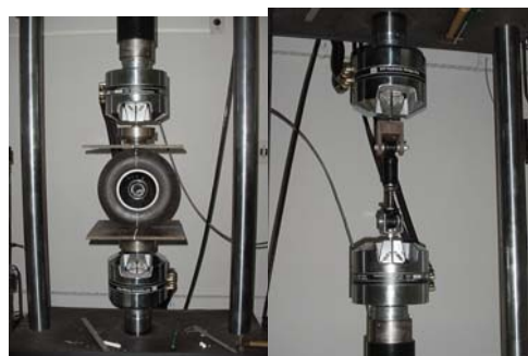
Figura 3: Ensaio experimentais para determinação dos parâmetros de rigidez para pneu e mola.
